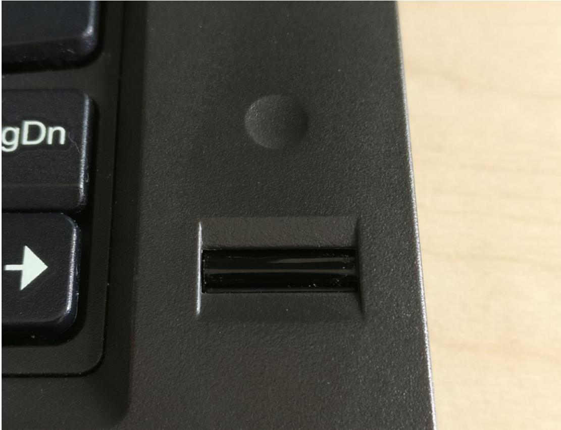
*Abbildung 9 Integrierter Fingerabdruck-Sensor eines Notebooks*
