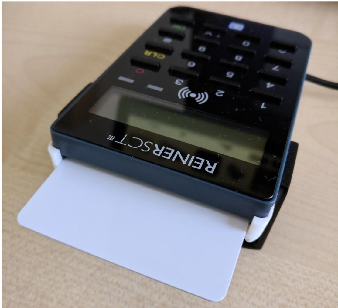
*Abbildung 10 Smartcard-Lesegerät mit Smartcard im Scheckkartenformat*
