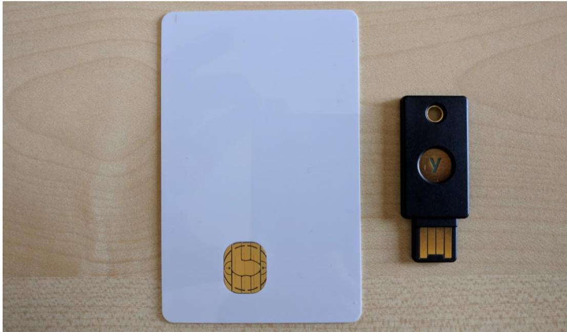
Abbildung 3 Smartcard im Scheckkartenformat und als Dongle mit Universal Serial Bus (USB)-Anschluss
